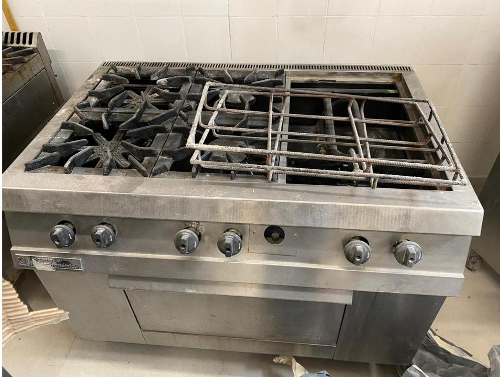
**COCINA 4 QUEMADORES PARA HORNALLA + 1 QUEMADOR PARA PLANCHA + HORNO 38.000 cal/h**
